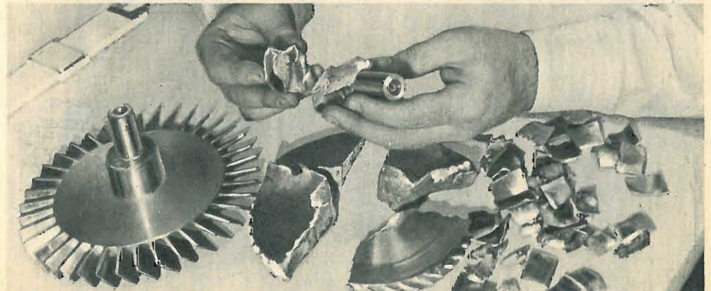
Una ruota intatta di turbina e, a destra, una spezzata, di cui vengono esaminati i frammenti.
