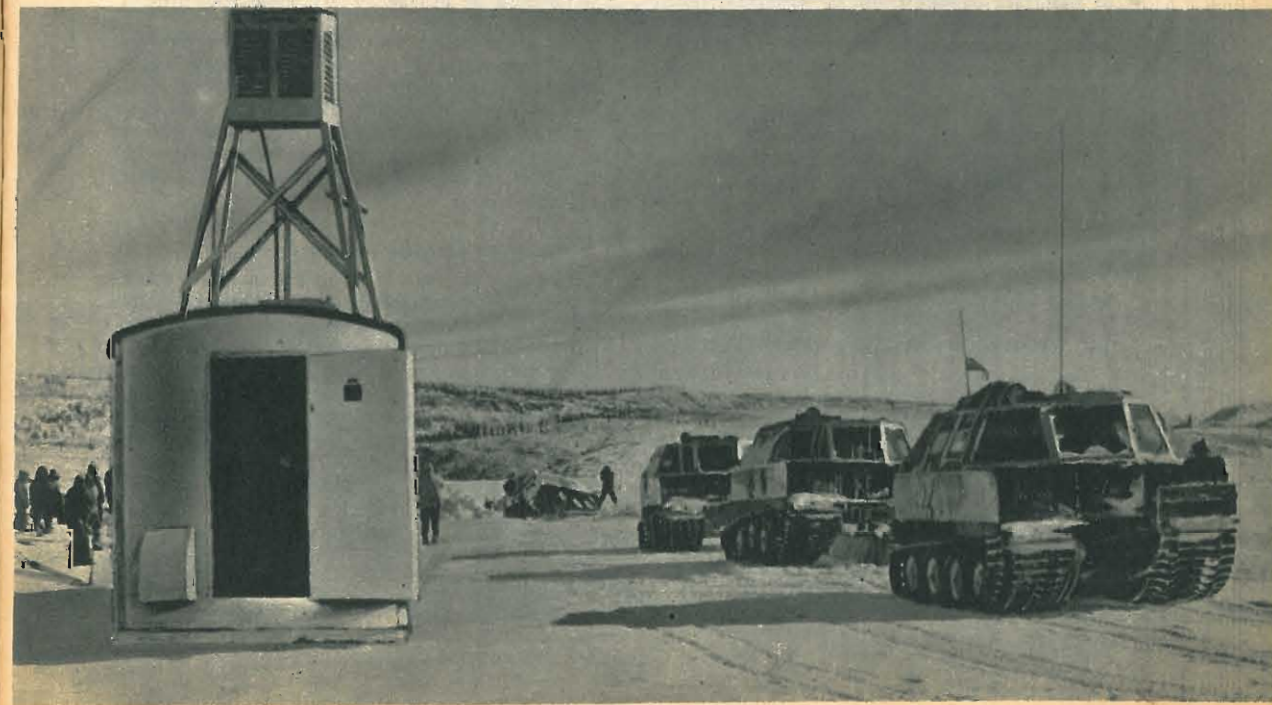
Fig. 6: Automezzi a cingoli (il primo con antenna radio) davanti a una stazione meteorologica che può funzionare a lungo senza sorveglianza. La gabbia sopraelevata contiene gli strumenti.
